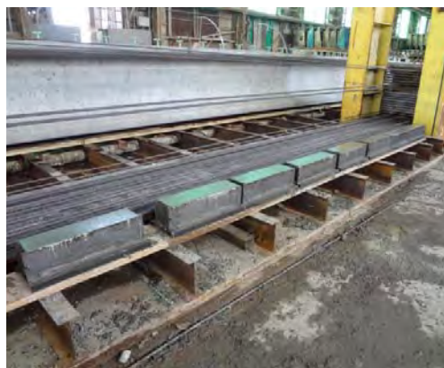
a) MOR Beams
